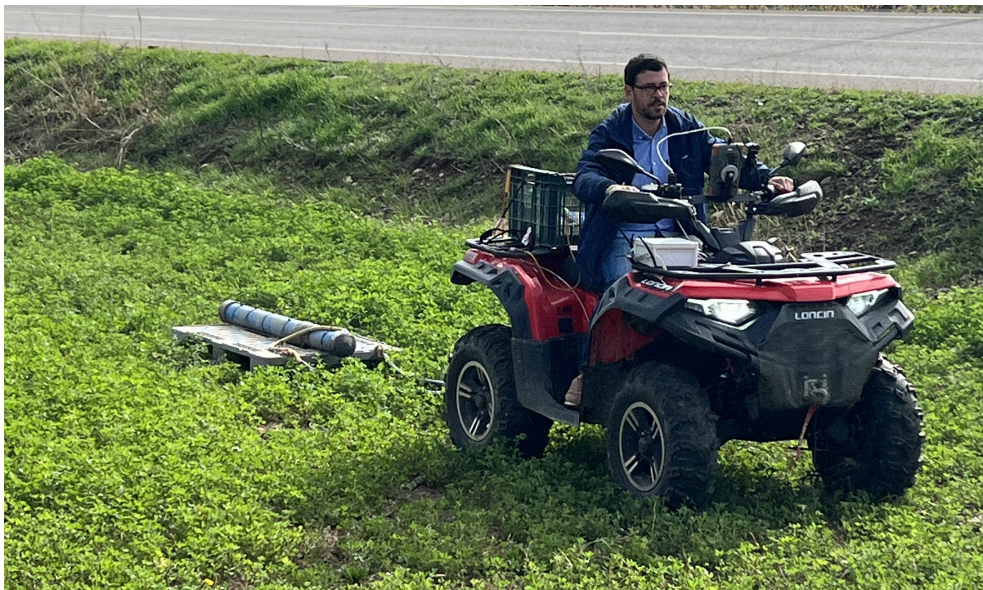
Imagen 6. Demostració del mapeig de la conductivitat elèctrica aparent del sòl amb el sensor Dualem.
